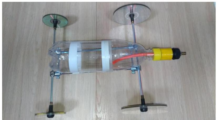
圖二:水動力火箭車完成模擬圖
